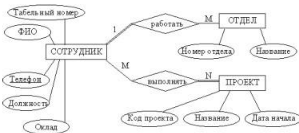
Рисунок 1. Пример ER–диаграммы с однозначными и многозначными атрибутами
